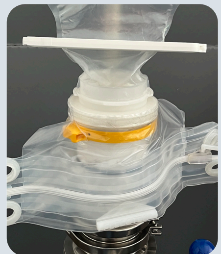
4. QuickTric Gesamtinstallation mit Flecozip Sekundäreinhausung
