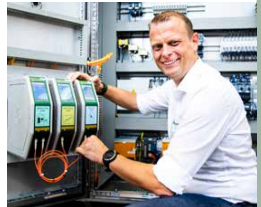
Sichere Kommunikation: Gert Hansen demonstriert die Module der Pharma-Plattform, deren besonders geschützter Bereich Daten nach außen senden, aber nicht empfangen kann.
